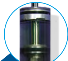
Пінення відсутнє у газовому амортизаторі
