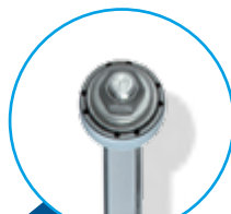
Поршень двотрубного амортизатора
