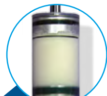
Пінення у оливному амортизаторі (технологія без тиску газу)
